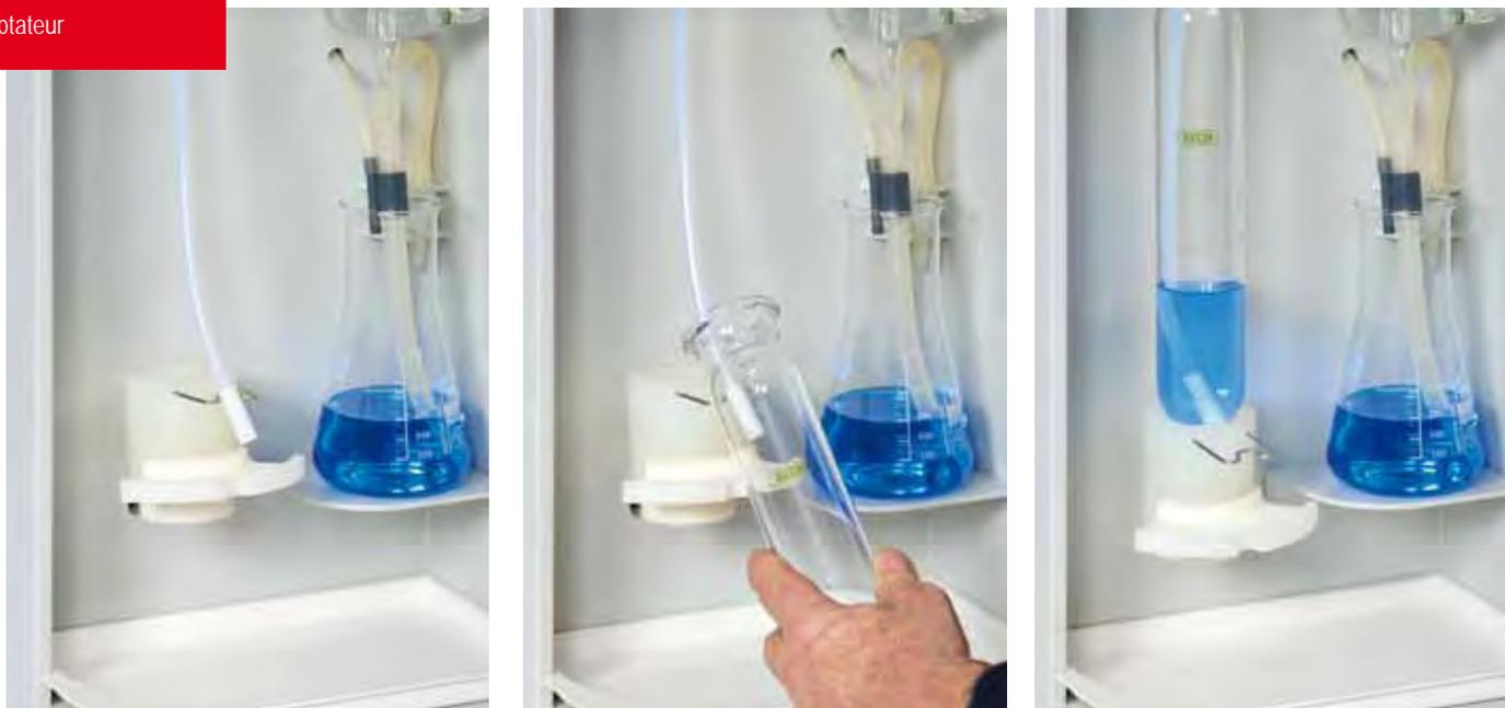
Notre adaptateur pratique permet d'utiliser, dans nos appareils de distillation à la vapeur d'eau behrotest®, des récipients de distillation de fabricants s'éloignant des dimensions standard.
