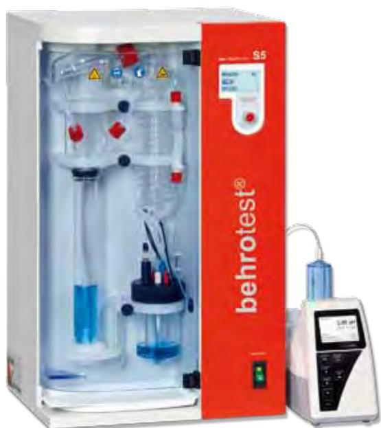
Appareil de distillation à la vapeur d'eau S 5 avec addition automatique de NaOH, H<sub>2</sub>O et H<sub>3</sub>BO<sub>3</sub>, avec aspiration automatique des restes d'échantillon, avec 99 programmes et une possibilité de raccordement à un appareil de titrage externe
